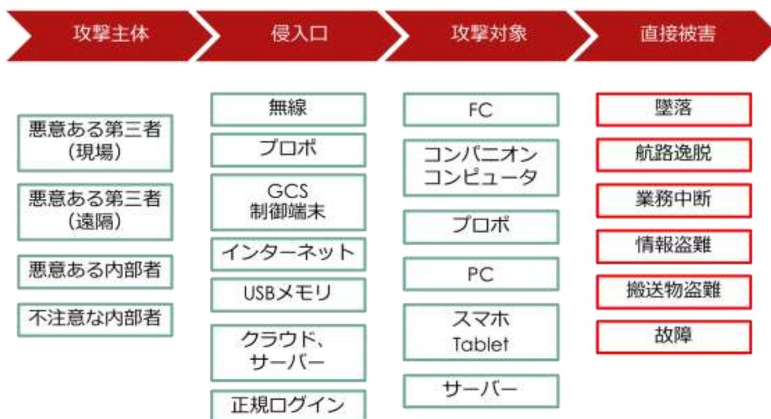
図 17：ドローンのリスクの侵入モデルと直接被害
