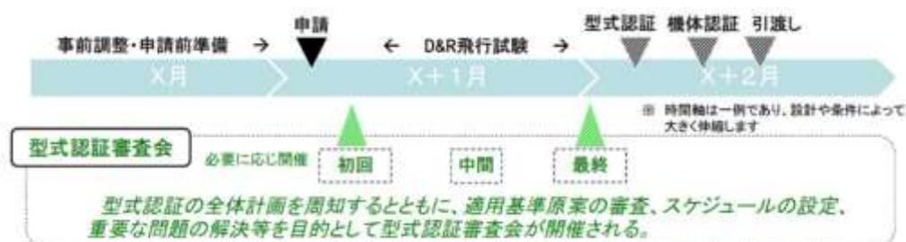
図 2：ドローンの機体認証型式認証の流れ
